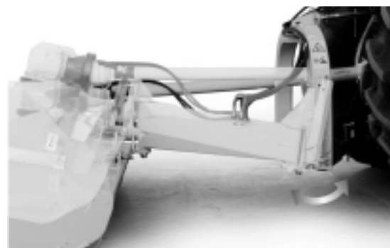
Attelage oscillant permettant le suivi du dénivellement du terrain
