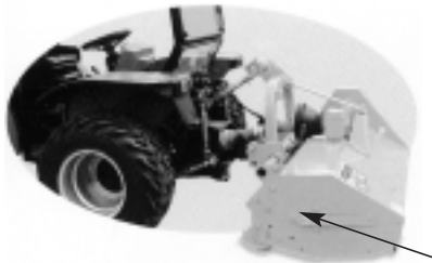
Version pour attelage frontal ou pour tracteur à poste réversible Roulement interne
